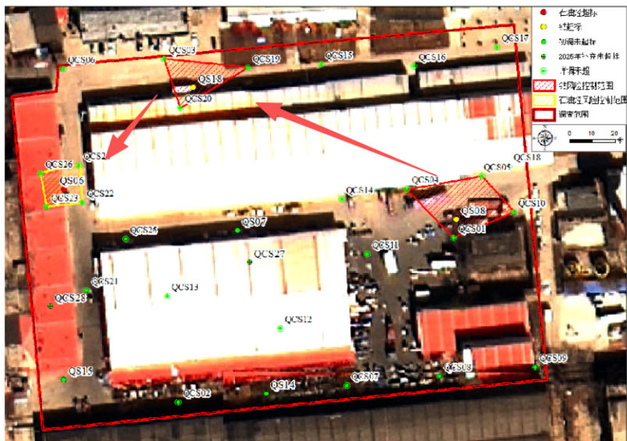
图 4.2-5 污染基坑清挖顺序
