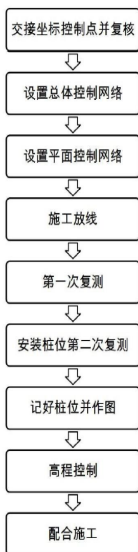
图 4.2-5 测量控制流程
